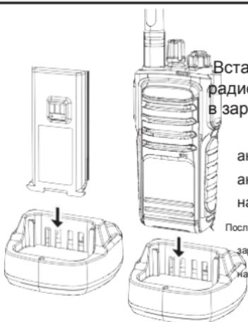
Вставьте аккумуляторную батарею или радиостанцию с аккумуляторной батареей в зарядный стакан.
