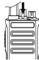
Поверните переключатель каналов для выбора нужного канала. Если принимается радиопередача, будет слышен звук из громкоговорителя.
